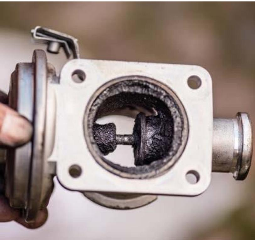
lizzata dall'uso cittadino. Accensioni e spegnimenti continui del veicolo non permettono al motore di raggiungere la corretta temperatura di esercizio e, poiché la valvola EGR a motore freddo viene esclusa, questo provoca un accumulo di impurità su di essa e sullo scambiatore di calore.
