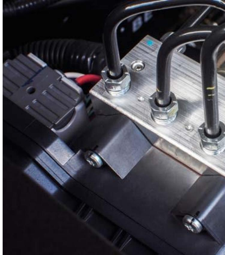
**I**l sistema ABS è una componente della sicurezza attiva, il cui fine è evitare il bloccaggio delle ruote in fase di frenata, assicurando una maggiore stabilità del veicolo.
